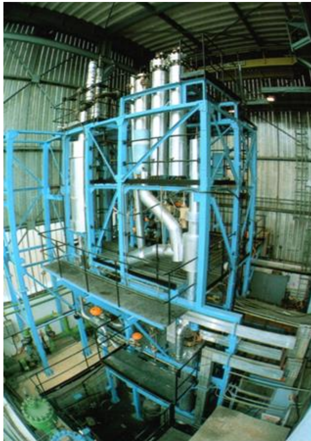
12. ábra: A PMK-2 kísérleti berendezés a paksi blokkok jellemzőinek vizsgálatára (MTA EK)
