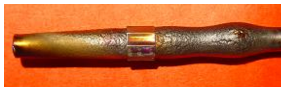
8. ábra: Magas hőmérsékleten felfúvódott fűtőelemek (© MTA EK)
