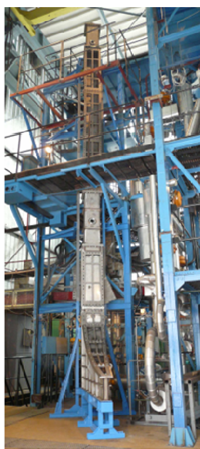
Kísérleti berendezés a paksi tartály külső hűtésének vizsgálatára (CERES, AEKI)
