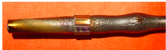
Magas hőmérsékleten felfűvódott fűtőelemek (© AEKI)
